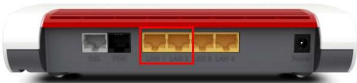
**Modell 7590:** Stecken Sie das mitgelieferte Netzwerkkabel in die Buchse WAN der FRITZ!Box und am LAN-Anschluss der Wandsteckdose. Verbinden Sie die FRITZ!Box mit einem weiteren Netzwerkkabel über die Buchse LAN1 mit der Netzwerkschnittstelle Ihres PCs oder per WLAN.
