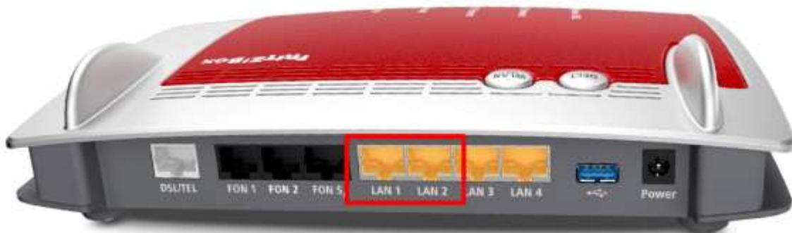
**Model 7530:** Stecken Sie das mitgelieferte Netzwerkkabel in die Buchse LAN1 der FRITZ!Box und am LAN-Anschluss der Wandsteckdose. Verbinden Sie die FRITZ!Box mit einem weiteren Netzwerkkabel über die Buchse LAN2 mit der Netzwerkschnittstelle Ihres PCs oder per WLAN.
