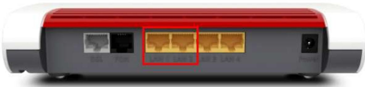
**Modello 7590:** Inserite il cavo di rete in dotazione nella presa WAN del FRITZ!Box e nella presa LAN della presa a muro. Collegate il FRITZ!Box con un altro cavo di rete tramite la presa LAN1 all'interfaccia di rete del PC o tramite Wi-Fi.
