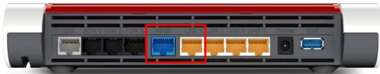
**Modello 4020/4040:** Inserite il cavo di rete in dotazione nella presa WAN del FRITZ!Box e e nel collegamento LAN della presa a muro. Collegate il FRITZ!Box con un altro cavo di rete tramite la presa LAN4 all'interfaccia di rete del PC o tramite Wi-Fi.
