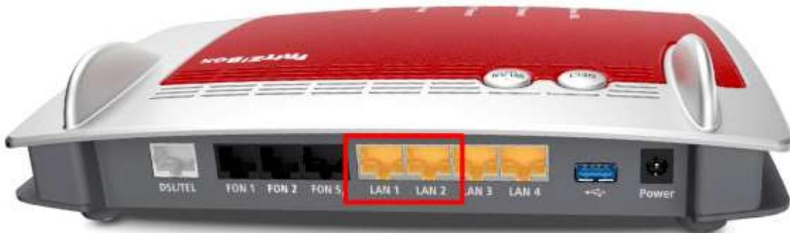
**Modello 7530:** Inserite il cavo di rete in dotazione nella presa LAN1 del router FRITZ!Box e nel collegamento LAN della presa a muro. Collegate il router FRITZ!Box con un altro cavo di rete tramite la presa LAN2 all'interfaccia di rete del PC o tramite Wi-Fi.
